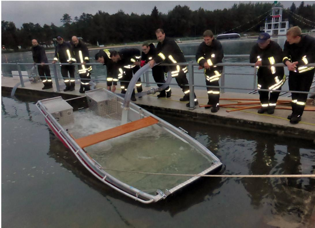
Der „Füllversuch“ beweist es. Das Boot ist unsinkbar. Allerdings funktioniert das Selbstlenzen bei diesem Füllungsgrad nicht mehr, weil der Ausgang des Ventils unter Wasser liegt.
