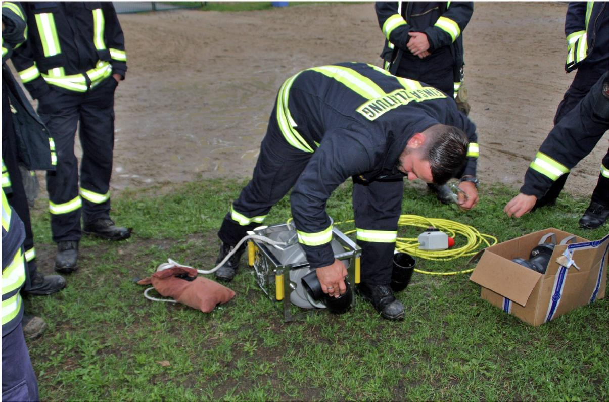
Inzwischen beginnt die Ausbildung an den „Chiemseepumpen“, die bis zu 8 cm große Gegenstände, in gewissen Grenzen auch kleinere, textile Stücke durchsaugen können. Der Saugstutzen kann in verschiedene Positionen gebracht werden. So kann das Wasser bis auf 1 cm Höhe abgesaugt werden.
