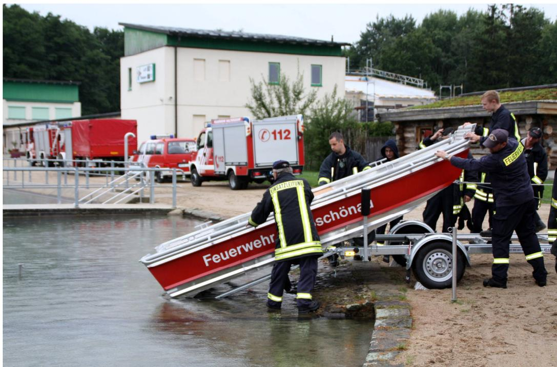
Mit Hilfe des Trailers samt Rampe, der auch in das Wasser hineingefahren werden kann, lässt sich das Boot gut zu Wasser bringen. Zum Aufsatteln ist ein handbetriebener Seilzug mit Sperre vorgesehen.
